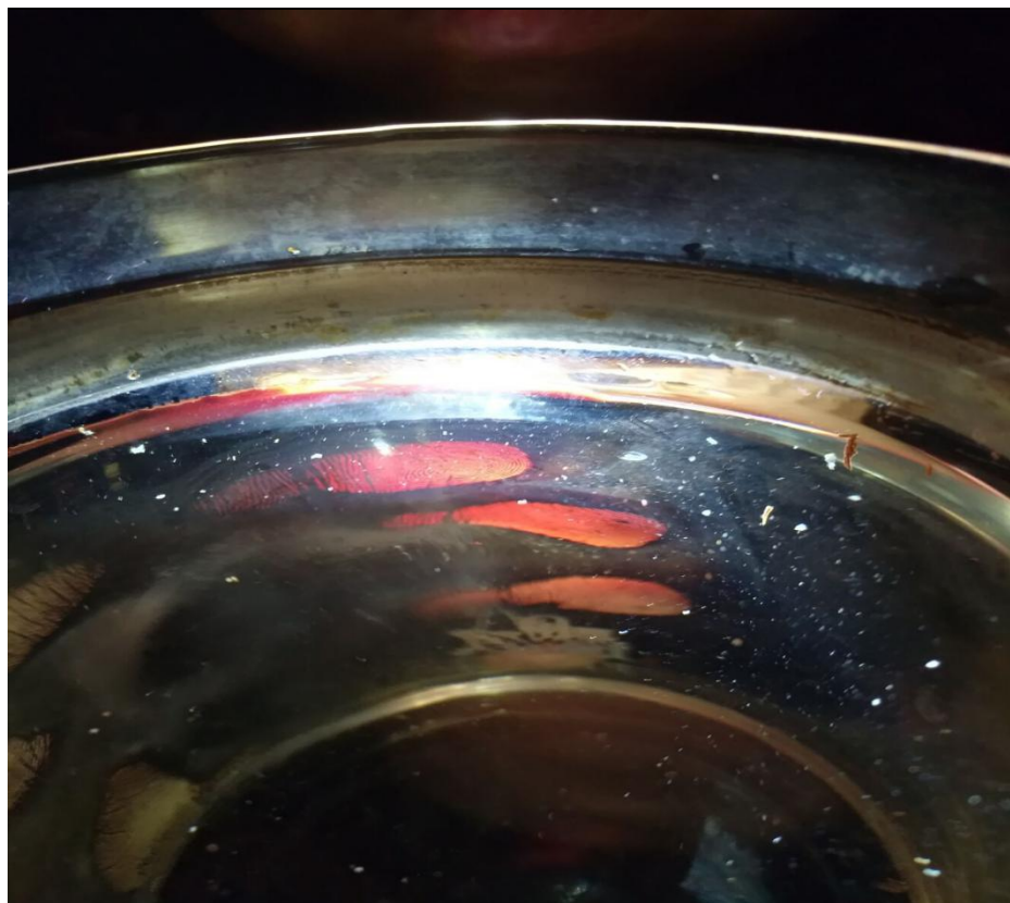
图 5 关掉其他光源用手电筒照射拿玻璃杯的手指从上方看到的指纹图像
